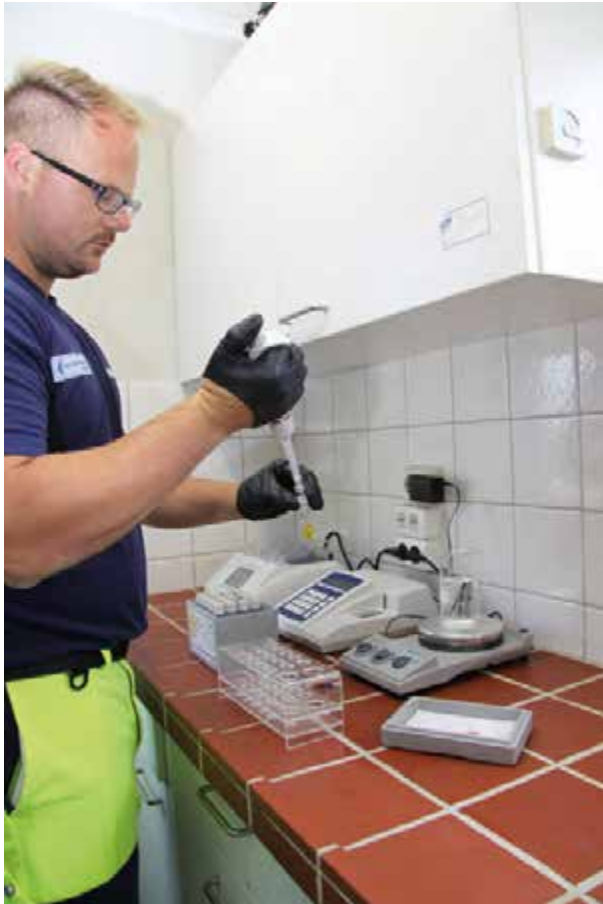
Schnellanalyse im eigenen Labor an der Kläranlage Nordstrand: u.a. Stickstoff, Phosphor, Organische Säuren, Metalle, Kohlenwasserstoffe
